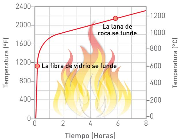
En una aplicación en la cual las temperaturas elevadas pueden causar problemas, la lana de roca proporcionará mayor protección que la fibra de vidrio. La temperatura máxima de servicio del aislante de lana de roca, al someterse a prueba conforme al estándar ASTM C411, es de 650 °C (1200 °F), en comparación con la fibra de vidrio que está limitada a una temperatura máxima de servicio de 232 °C (450 °F).
