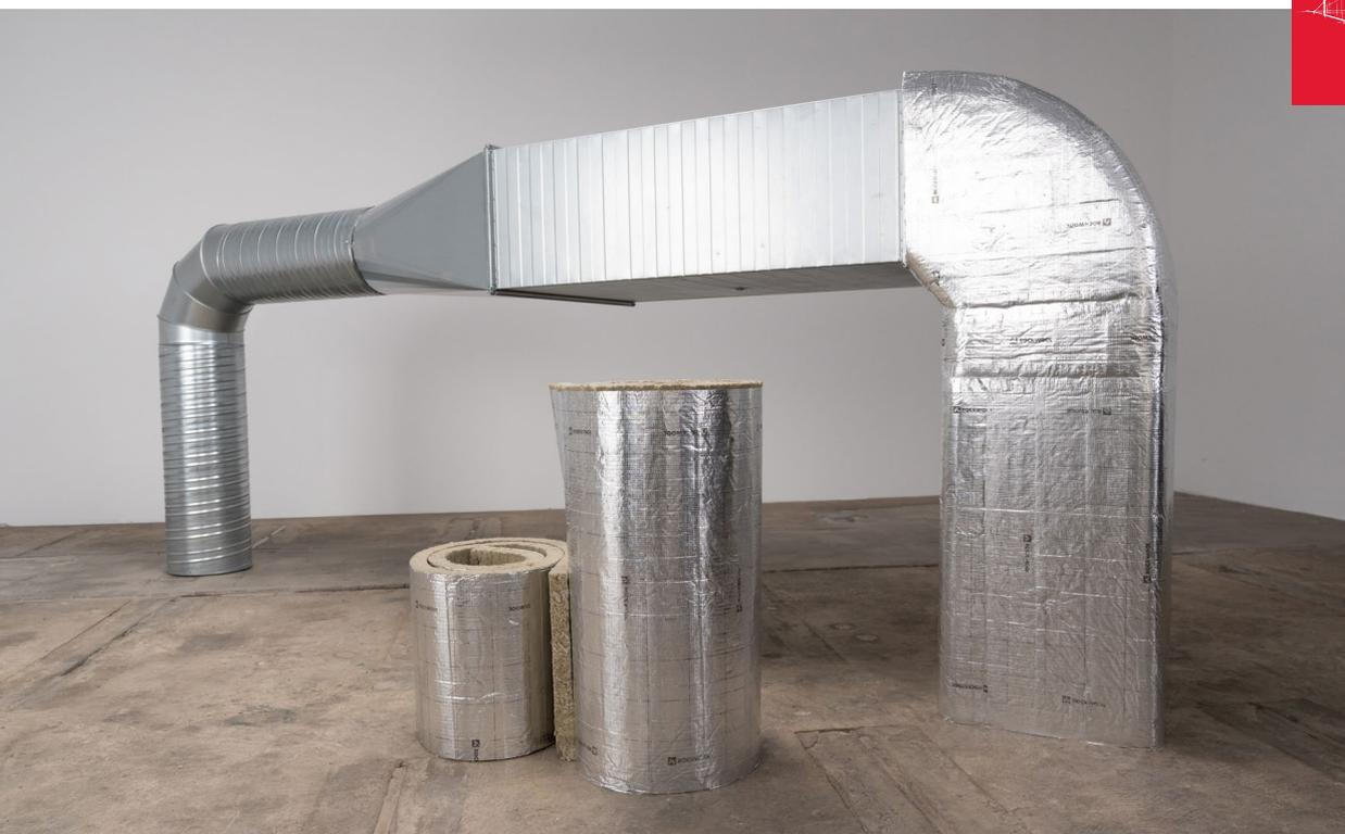
ROCKWOOL LM Klima ist eine nichtbrennbare druckfeste Steinwolle-Lamellenmatte, die einseitig mit einer gitternetzverstärkten reißfesten Aluminiumfolie kaschiert ist. Rastermarkierung auf der Aluminiumfolie für einfachere und schnellere Verarbeitung.
