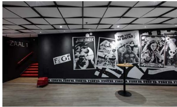
Voor het indrukwekkende plafond werd Rockfon Blanka® gebruikt in combinatie met een nieuwe 3D-toepassing van de Rockfon Color-all® onderconstructie.
