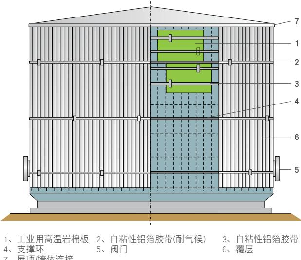
1、工业用高温岩棉板 2、自粘性铝箔胶带(耐气候) 3、自粘性铝箔胶带
