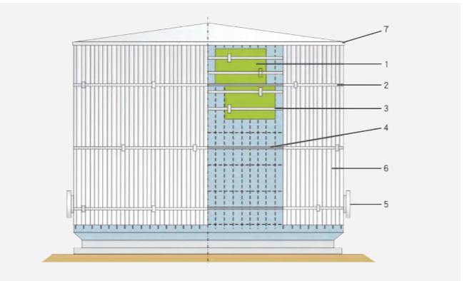
1、工业保温岩棉板 2、自粘性铝箔胶带(耐气候) 3、自粘性铝箔胶带
