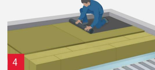
4 最外层使用沥青或高分子卷材防水层覆盖，并且使用机械固定。
