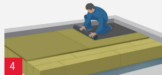
4 最外层使用沥青或高分子卷材防水覆盖，并且使用机械固定，有效抵抗风荷载。
