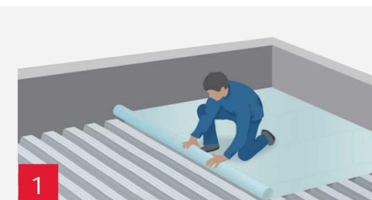
1 在钢结构基层上铺设隔汽层。
