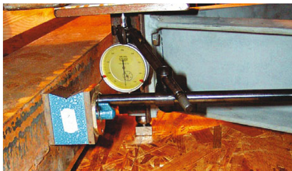
Měření průhybů podlahy (obr. 41)
