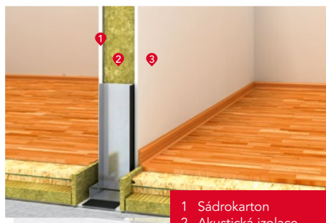
Izolace dělicí příčky
