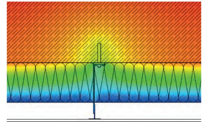
Beispielhafter Wärmedurchgang an einer Wandhalterung
