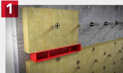
Anbringen der Flächendämmung mit einer Schablone
