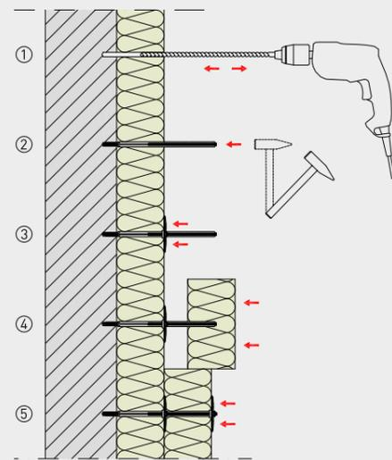
Ein- und zweilagige Verlegung der Fixrock Dämmplatten
