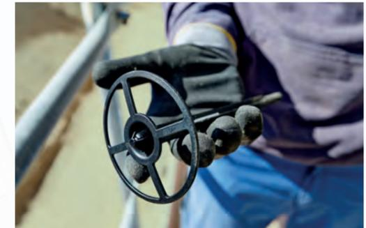
Der zweiteilig zu verwendende Dämmstoffhalter entspricht der eingesetzten Dämmstoffdicke. So benötigt man z. B. für eine Dämmstoffdicke von 160 mm einen Schaft DH 160 und einen Teller.
