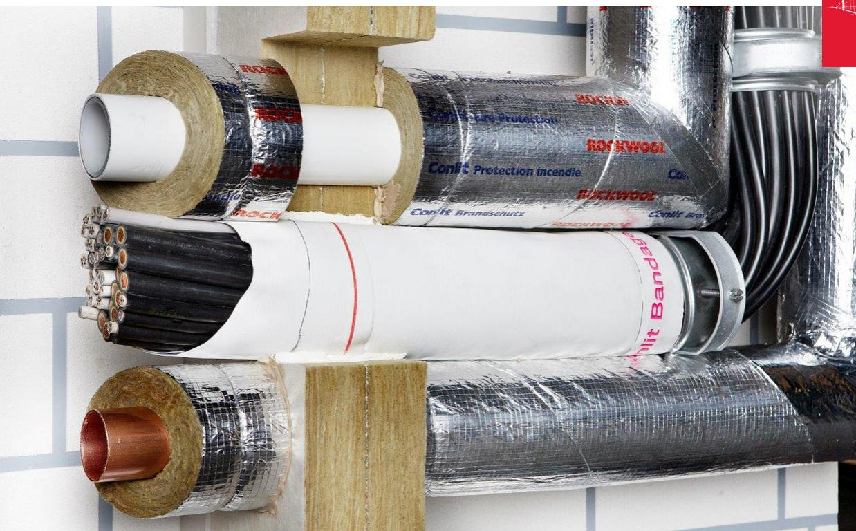
Das Conlit Penetration Board ist eine nichtbrennbare druckfeste Steinwolleplatte, die auf der Vorderseite mit einem weißen Glasvlies und auf der Rückseite mit einer gitternetzverstärkten farbig gekennzeichneten Aluminiumfolie kaschiert ist.
