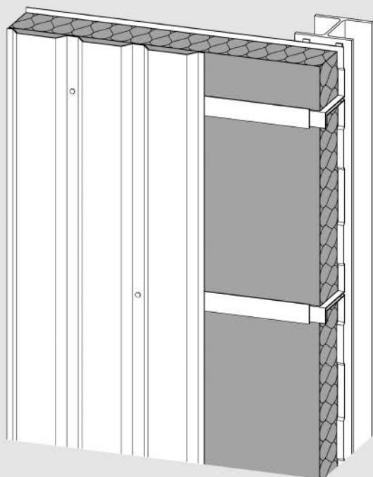
Kunstharzgebundene Steinwolle-Dämmplatte\* mit hoher Wärme- und Schalldämmwirkung. Sie ist elastisch und passt sich fugenlos der Konstruktion an.
