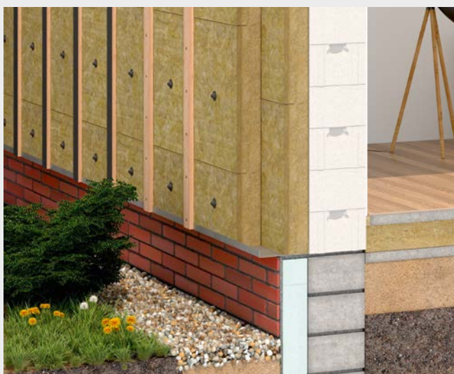
3. Seejärel kinnitatakse tuulutusroovid ja soojustusplaadid teraskruvidega otse kandvale seinalle (vertikaalsuunas 300-750 mm sammuga). Roovide välispinnale kinnitatakse hüdroisolatsiooniriba.
