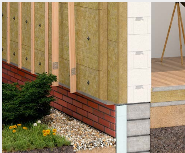
2. Tuulutusroovi küljele kruvitakse naelutusplaadid sammuga 1 m (ogadega väljapoole), seejärel paigaldatakse roovid soojustuskihile, asetades need iga 300-600 mm järel ning surutakse vastu kivivillaplaate nii, et plaatides olevad ogad läheksid soojustuskihi sisse.
