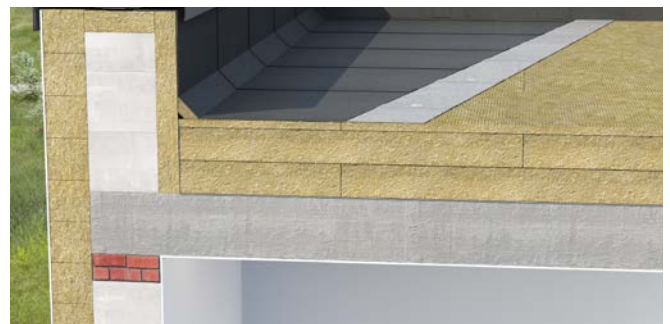
4. Paigaldatakse katuse ilmastikukindel bituumen- vms kate
