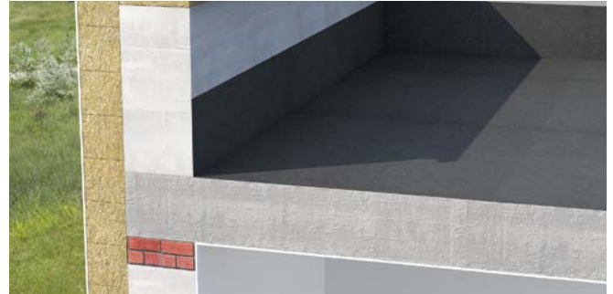
1. Olemasoleva katuse aluspinna ettevalmistamine, aurutõkke paigaldus
