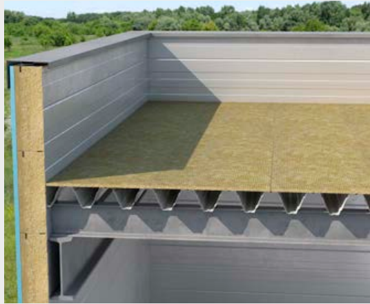
1. Profileeritud terasplekile laotatakse 70 mm paksused plaadid ROOFROCK 50 , mis on pidevaks ja stabiilseks aluseks aurutõkkekihile.
