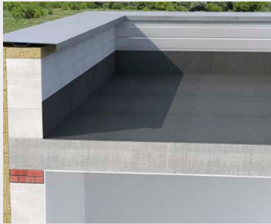
1. Tasasele, puhtale ja kuivale raudbetoonalusele paigaldatakse kiledest auruisolatsioonikiht.
