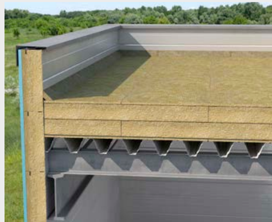
4. Pärast katuse soojusisolatsiooni põhikihi plaatide laotamist paigaldatakse katuse soojusisolatsiooni ülemine kiht 30 mm paksustest TF-BOARD / ROOFROCK 80 / ROOFROCK 60 või 40 mm paksustest plaatidest ROOFROCK 50 või 50 mm paksustest plaatidest HARDROCK MAX .
