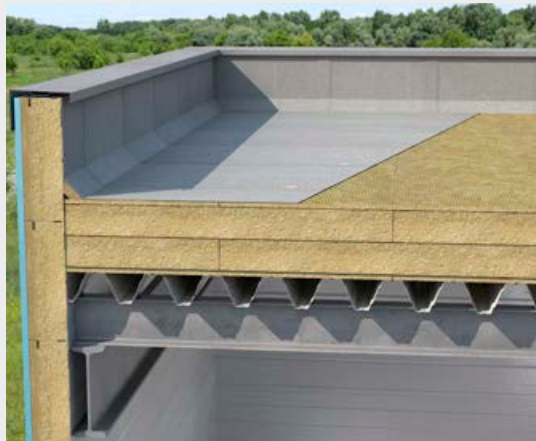
5. Pärast katuse soojusisolatsiooni laotamist paigaldatakse hüdroisolatsiooni katusekate. Alumise kihi hüdroisolatsioonikatte paigaldamisel kinnitatakse tala külge ka soojusisolatsioon ja selle kattekiht. Selleks kasutatakse mehhaanilisi kinnituselemente – teleskoopilisi tappe.
