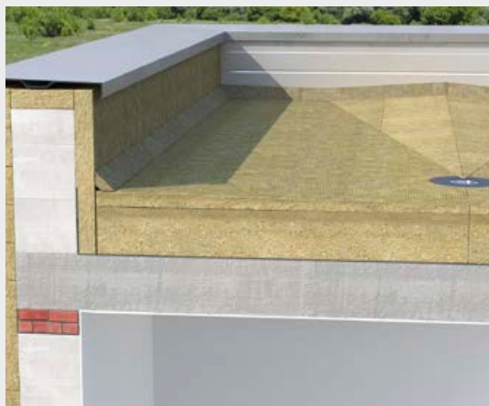
3. Pärast katuse soojusisolatsiooni laotamist edasi paigaldatakse hüdroisolatsiooni katusekate. Selleks kasutatakse enamasti PVC-membraani ja see kate kinnitatakse alusele.
