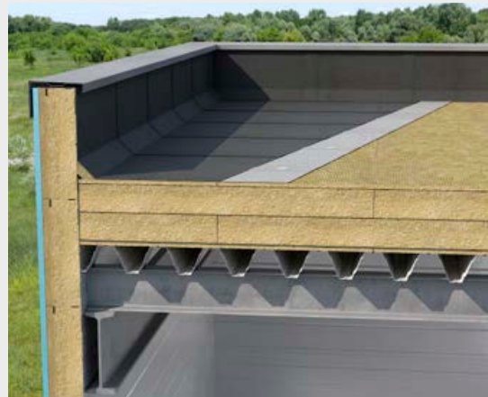
6. Katuse paigaldustööd lõpetatakse pealmise hüdroisolatsioonikihiga. Selle kihi vuugid tuleb alati alumise kihi suhtes nihutada nii, et vuugid ei kattuks.
