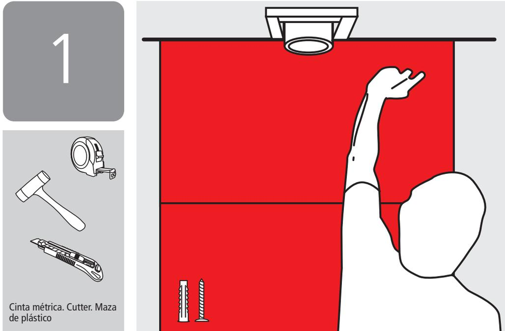
**Colocar los paneles en contacto con la pared** desde el falso techo hasta el suelo. Se recortarán para que queden a presión y se fijarán con ayuda de las chapas metálicas (2 por panel, tornillos y tacos de 5 mm Ø). Uniremos mediante cinta adhesiva de aluminio.
