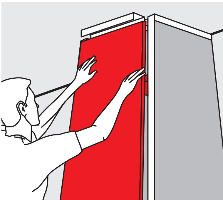
**Colocación de la placa frontal y rejuntado.** Para finalizar, unir las juntas de las placas utilizando la venda de separación y pasta de rejuntado: Para las esquinas aplicar la cinta especial para esquinas y pasta de rejuntado.
