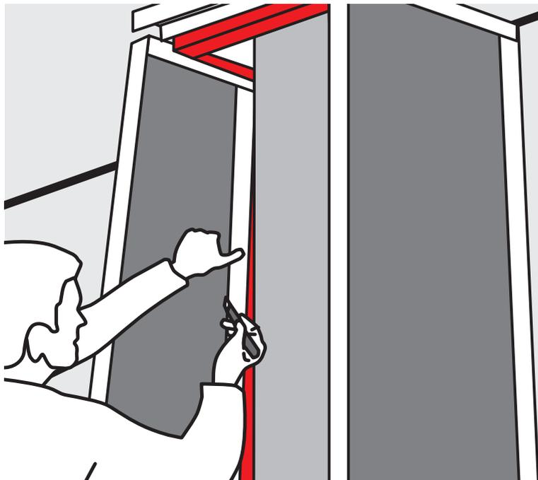
**Placas de yeso.** Las placas de yeso laminado se sitúan frente a las canales y se atornillan con tornillos de pladur. Se recortarán las placas con cutter desde la parte interior y repasando los cortes desde el exterior.
