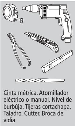
Cinta métrica. Atornillador eléctrico o manual. Nivel de burbúja. Tijeras cortachapa. Taladro. Cutter. Broca de vidia
