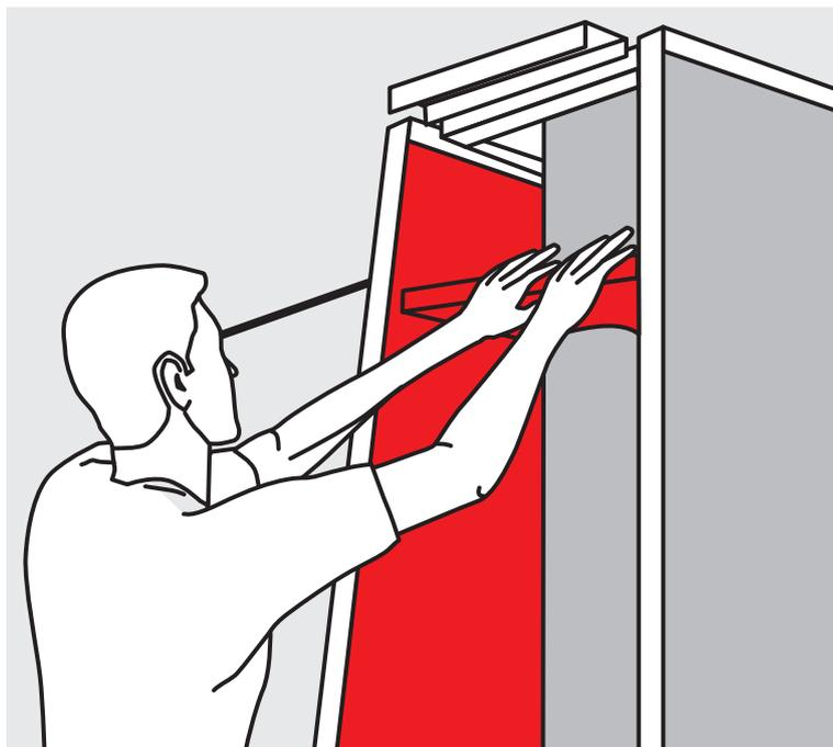
**Colocación del panel de separación entre la cámara de descompresión y cámara de recuperación.** La cámara de descompresión tendrá unos 30-40 cm de altura. Colocar el panel divisorio utilizando el tubo para dibujar su contorno sobre el panel Firerock. Vaciar con un cutter, y adaptarlo a la distancia entre las placas laterales. Colocarlo haciendo una ranura en el ancho. Para las juntas utilizar cinta adhesiva.
