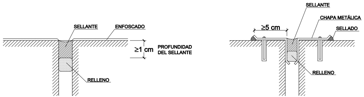
Figura 2.6 Ejemplos de juntas de dilatación
