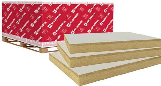
Panneau rigide en laine de roche double densité. Face supérieure à plus haute densité avec une grande résistance aux passages répétés et au poinçonnement et un revêtement qui facilite l'adhérence des feuilles bitumineuses et synthétiques.
