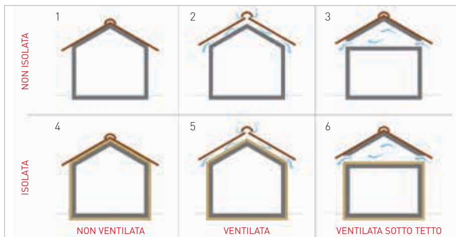
Figura 2.3 - Schema funzionale delle coperture a falda
