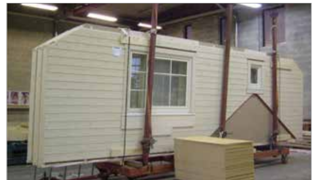
Figura 3.23 Pannello completo di impianti e serramenti.
