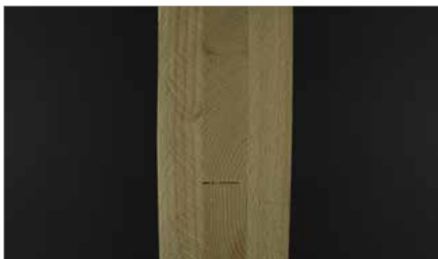
Figura 3.6 - Pannello XLam ottenuto con tre strati di tavole.
