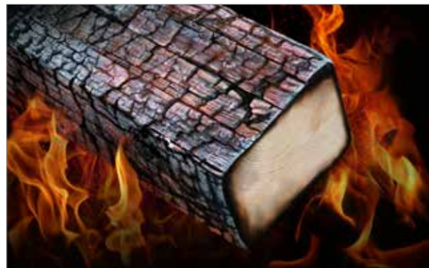
Figura 2.21 - La carbonizzazione della superficie del legno protegge gli strati interni.
