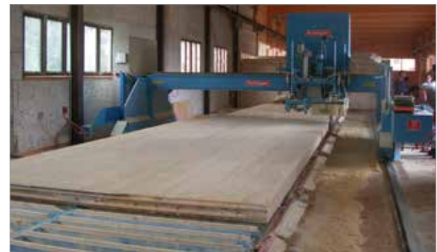
Figura 3.4 - Il taglio di un pannello XLam con tavole incollate.
