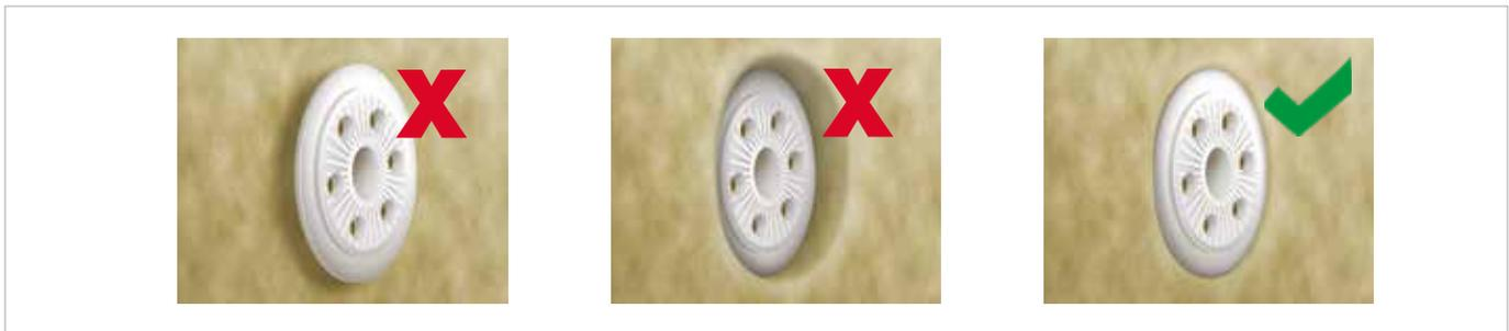
Figura 18 - A sinistra e al centro, errori nel posizionamento dei tasselli di vincolo meccanico dell'isolante; a destra, corretta modalità di posa nel caso di montaggio a filo
