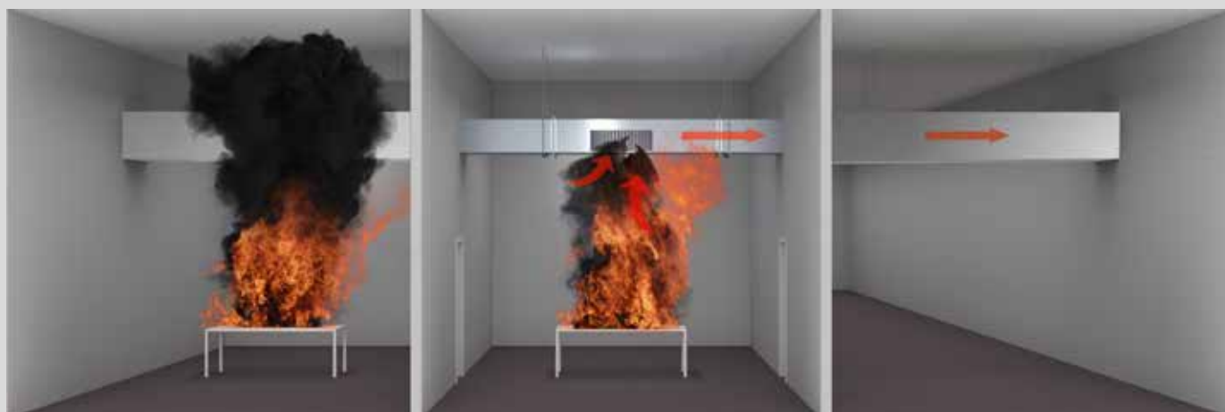
Condotta sottoposta a fuoco dall'esterno (o → i)
