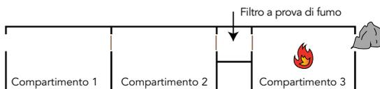
I compartimenti 1 e 2 sono a *prova di fumo* proveniente dal compartimento 3 e viceversa.
