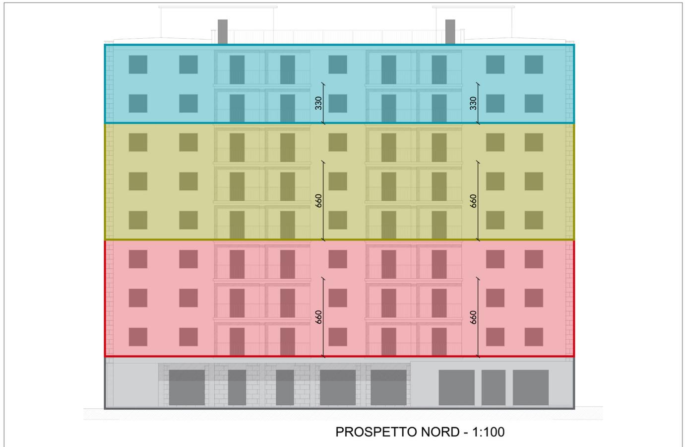
Figura 4. Prospetto Nord di progetto con evidenza delle quote interpiano e dei compartimenti antincendio
