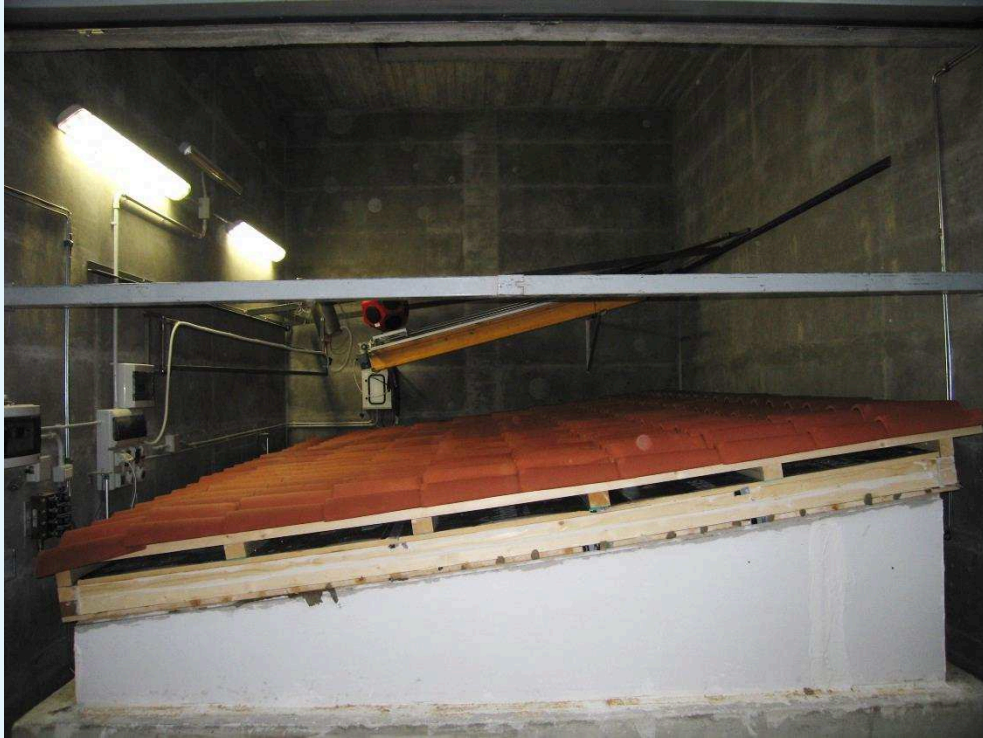
Fotografia del campione, lato camera emittente.
