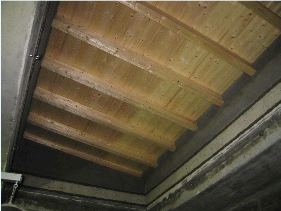
Fotografia del campione, lato camera ricevente.
