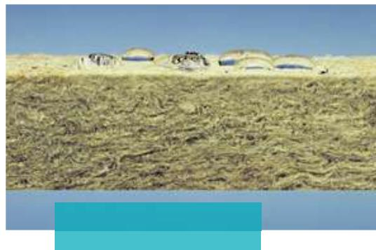
**安全:** ROCKWOOLのストーンウールは、火災の際に最も安全な素材の1つです。不燃性であり、有毒ガスを放出しません。ストーンウールは、家や建物で使用するだけでなく、作業するにも安全な素材です。これは、製品の安全性に関する最新の規制とテストによって確認されています。
