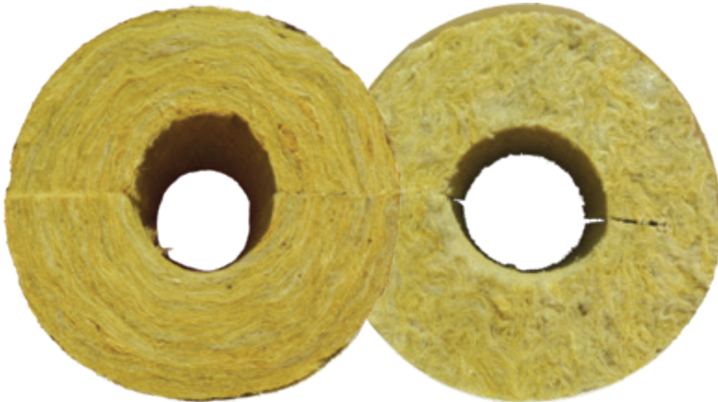
ROCKWOOL 800 kevalų laminarinė plaušų struktūra
