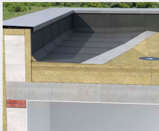
4. Stogo įrengimo darbai užbaigiami eilės tvarka klojant sekančius apželdinto stogo įrengimui reikalingus sluoksnius (žiūrėti lentelę žemiau).
