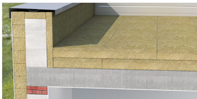
2. Montuojamas pagrindinis šiltinimo sluoksnis
