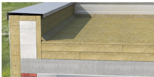
3. Montuojamas viršutinis šiltinimo sluoksnis
