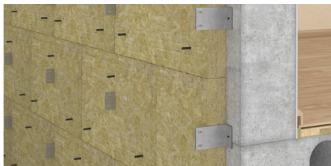
2. Pirmo šiltinimo sluoksnio plokščių montavimas
