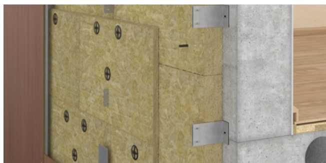
4. Išorės apdailos plokščių montavimas
