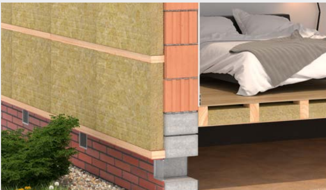
3. Sumontavus karkaso elementus įrengiamas pirmasis pagrindinės termoizoliacijos sluoksnis iš akmenų vatos plokščių SUPERROCK ar SUPERROCK PREMIUM ar ROCKTON PREMIUM . Jos montuojamos jas įspraudžiant tarp medinių tašų taip, kad užpildytų visą erdvę ir patikimai priglustų prie tašų šonų. Akmenų vatos plokščių plotis turi būti apytiksliai 1-2 % didesnis nei atstumas tarp vidinių tašų kraštų. Plokštės turi būti priglundusios viena prie kitos, kad nesudarytų plyšių bei prispaustų prie šiltinamos sienos paviršiaus.
