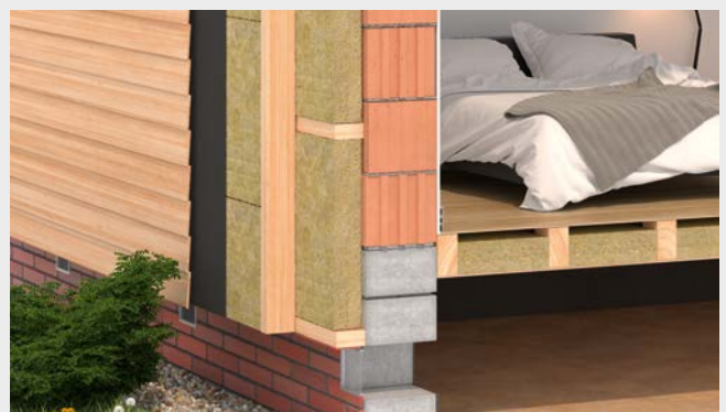
6. Įrengus vėjo izoliaciją iš difuzinės plėvelės ir suformavus oro tarpą iš papildomų vertikalių tašų – toliau prie jų galima tvirtinti apdailą iš pasirinktų fasado išorės apdailos medžiagų. Todėl būtina vadovautis fasadinių medžiagų gamintojo/tiekėjo rekomendacijomis, kuriose pateikiami reikalavimai konstrukcijai, medžiagų montavimo eiliškumas, tvirtinimas, papildomų elementų naudojimas ir t.t. Šiuo atveju naudojamos horizontalios medinės dailylentės, todėl jos gali būti tiesiogiai tvirtinamos prie anksčiau įrengtų papildomų vertikalių medinių tašų.
