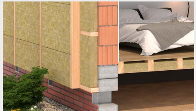
4. Tada ant pirmojo pagrindinio termoizoliacinio sluoksnio montuojamas kitas – vertikalus medinių tašų karkasas, kuris tvirtinasi prie horizontalių tašų. Antrajam šiltinimo sluoksniui naudojamos tos pačios akmenų vatos plokštės SUPERROCK ar SUPERROCK PREMIUM ar ROCKTON PREMIUM . Kaip ir aprašyta anksčiau jos montuojamos tokiu pačiu būdu įspraudžiant tarp medinių tašų, tik perstumiant plokštes, kad persidengtų jau sumontuotų plokščių sandūros bei nesudarytų išsiskyrimo plyšių per visą šiltinimo sluoksnį.
