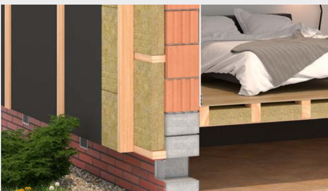
5. Vėjo izoliacijai yra naudojama difuzinė plėvelė, kuri parenkama pagal gamintojo rekomendacijas, bet visais atvejais turi būti laidi vandens garams. Plėvelė turi patikimai priglusti prie akmenų vatos plokščių paviršiaus siekiant apsaugoti vatą nuo vėdinamame tarpe judančio oro. Tam naudojami papildomi vertikalus mediniai tašai, kurie ne tik atlieka plėvelės tvirtinimo funkciją, bet ir formuoja oro tarpą, kurio minimalus plotis turi būti ne mažiau 25 mm, kad oro tarpe būtų užtikrinamas oro judėjimas. Gretimos plėvelės juostos turi būti perdengtos užleidžiant 100-150 mm ir perklijuotos lipniomis juostomis.
