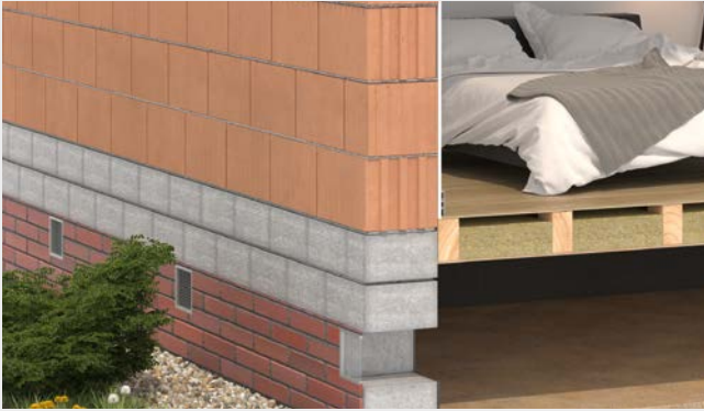
1. Laikančiosios sienos pagrindas prie kurio bus montuojami mediniai tašai turi būti lygus, tvirtas, švarus ir sausas.
