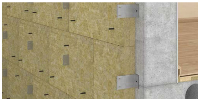
2. Siltināšanas pamatslāņa plātņu montāža
