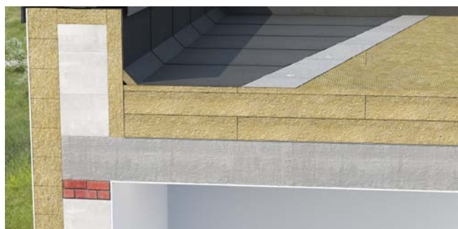
4. Jāiekļāj jumta bitumena hidroizolācijas segums
