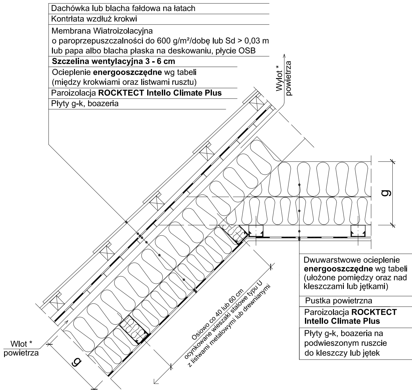
Energooszczędne ocieplenie dwuwarstwowe
