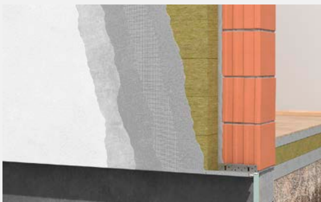
Nałożenie białego tynku mineralnego lub barwionego tynku silikatowego lub silikonowego.
