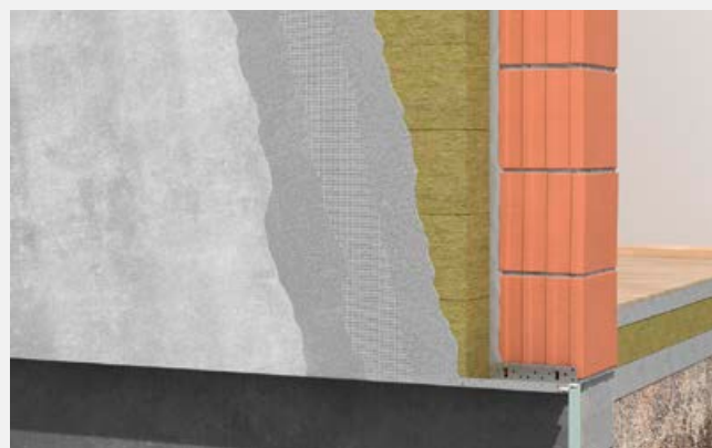
Malowanie podkładem tynkarskim w kolorze tynku.
