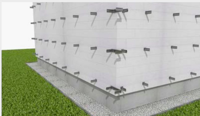
Montaż konsoli do ściany.
