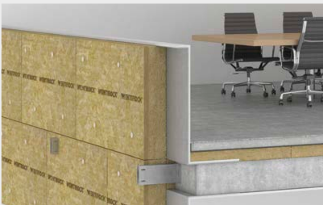
Ułożenie i zakotwienie zasadniczego ocieplenia z wełny.
