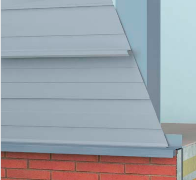
Mocowanie kaset ściennych do słupów stalowych.
