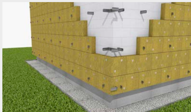
Ułożenie i zakółkowanie wełny do ściany.
