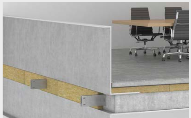
Uszczelnienie wełną na grubości stropu.
