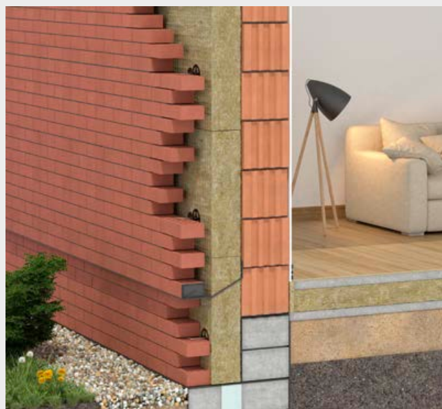
Wymurowanie warstwy osłonowej z klinkieru.
