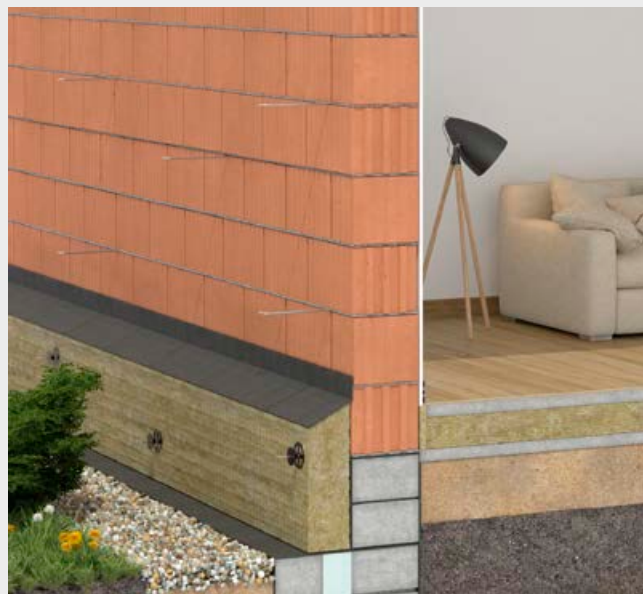
Ułożenie klina z wełny oraz założenie fartucha z papy.
