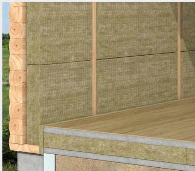
Ułożenie wełny między słupkami z zachowaniem pustki powietrznej między ociepleniem a balami.
