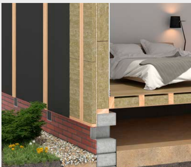
Zamocowanie wiatroizolacji i szerszych desek do rusztu.
