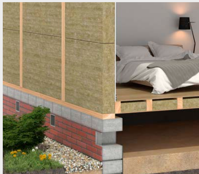
Ułożenie pierwszej warstwy wełny między słupkami drewnianymi.
