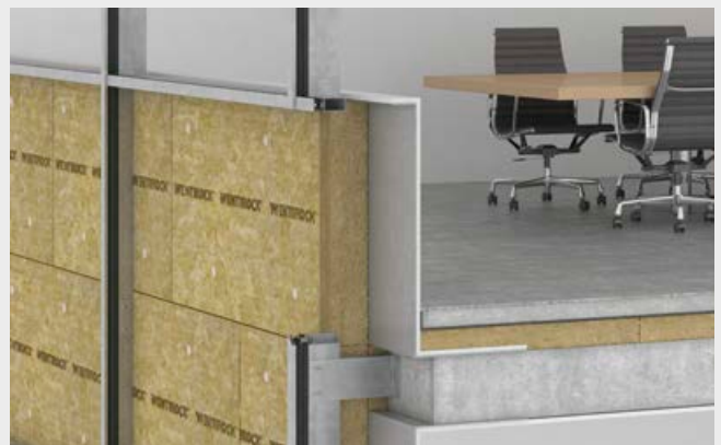
Montaż profili podkonstrukcji do konsol.
