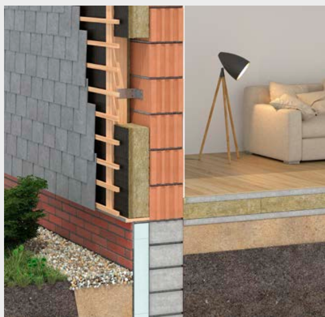
Montaż łupki za pomocą gwoździ, wkrętów lub klamer.
