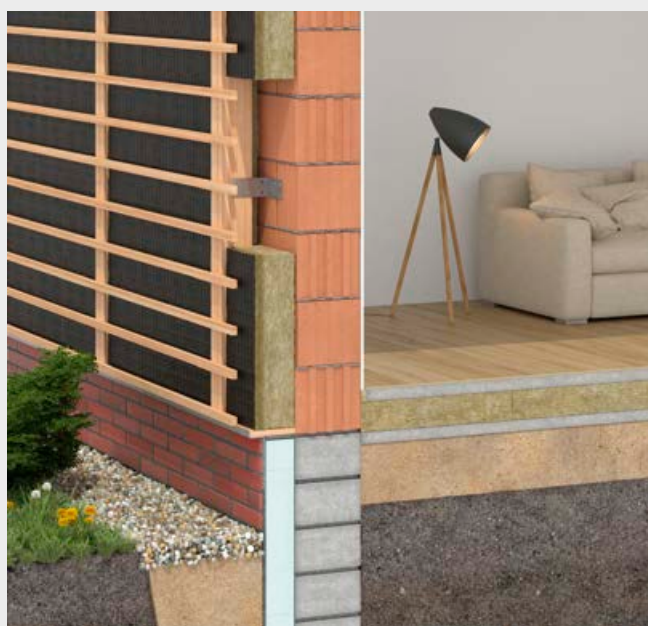
Zamocowanie łąt pod łupkę elewacyjną.
