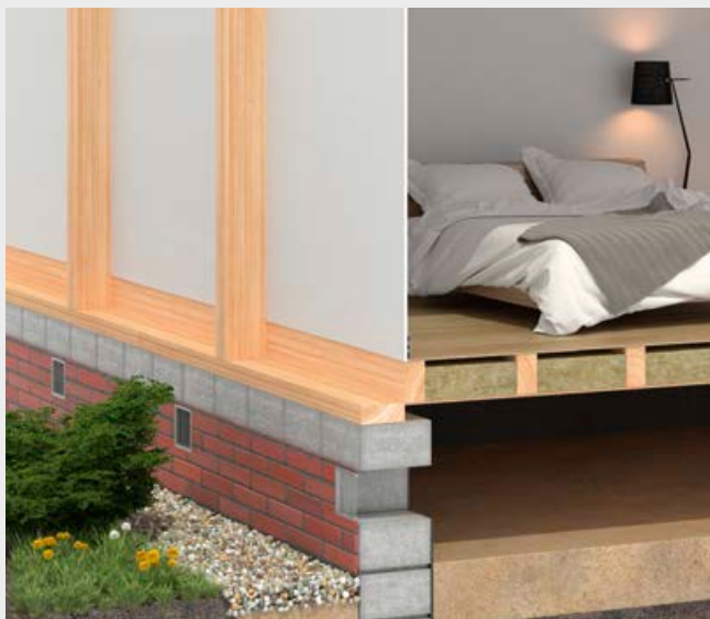
Szkielet drewniany ściany z zamocowaną od wewnątrz paroizolacją.
