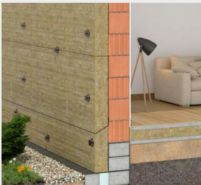
Założenie wełny na kotwy i dociśnięcie talerzykiem dociskowym.
