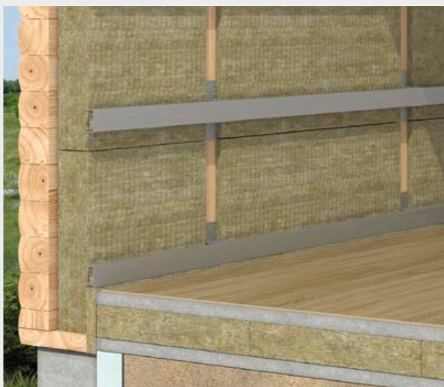
Mocowanie rusztu do słupków.
