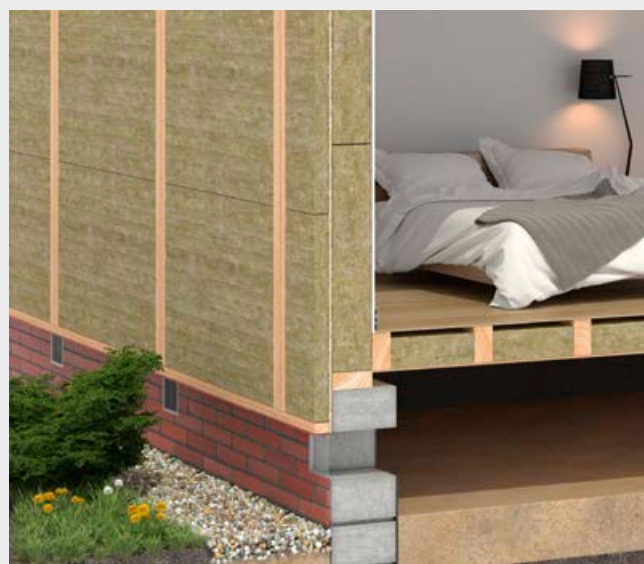
Ułożenie drugiej warstwy wełny między elementami rusztu.
