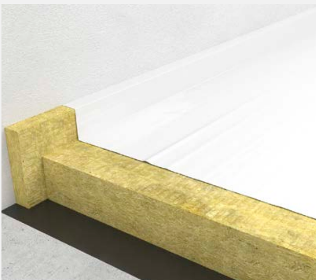
Rozłożenie folii z wywinięciem i sklejeniem na zakładach.
