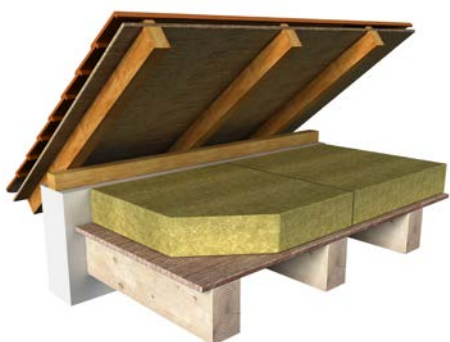
Zateplenie nepochôdznej podlahy na povale – izolácia v doskách v súvislej vrstve
